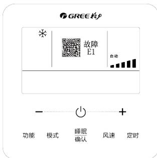
图7.1室外机高压保护故障界面
